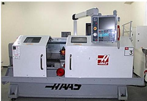
**Задание 1.** На рисунке показан внешний вид токарного станка с ЧПУ модели HAAS. Назовите основные узлы станка и их назначение
