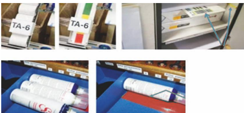
Минимальный уровень запаса бумаги отмечен карточкой заказа. Сигнал о необходимости дозаказа картриджа обозначен красным фоном.
